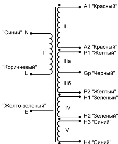
Рис. 1 Схема трансформатора.
