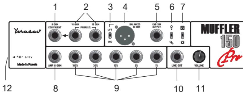
**1 - 8 OHM EQUIVALENT** - разъем для соединения с гнездами понижения мощности (9) при подключении двух кабинетов сопротивлением 16 ОМ в гнезда (2)
