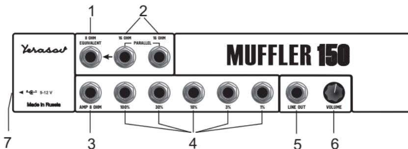
**1 - 8 OHM EQUIVALENT** - разъем для соединения с гнездами понижения мощности (4) при подключении двух кабинетов сопротивлением 16 ОНМ в гнезда (2)
