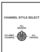
Усилитель позволяет выбирать один из двух вариантов звучания для каждого из каналов. В среднем положении переключателя все каналы работают в режиме MODERN. В правом положении переключателя все каналы работают в режиме VINTAGE. В левом положении переключателя канал 1 работает в режиме VINTAGE, а канал 2 - в режиме MODERN.
