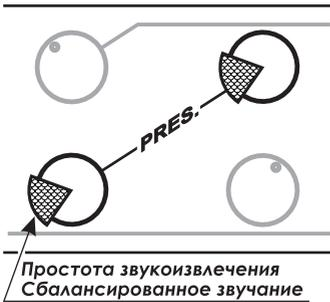
Регулятор PRESENCE управляет высокочастотным сигналом каждого из каналов. Диапазон частот, на которые он воздействует, расположен выше диапазона частот, управляемых с помощью регулятора TREBLE. Регулятор функционирует независимо от других регуляторов управления тембром и способен кардинальным образом изменить звук. По сути дела он является глобальным регулятором тембра. В канале 1 регулятор PRESENCE расположен в усилителе мощности, а в канале 2 – в предусилителе.
