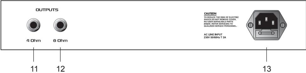
11 - гнездо для подключения внешнего кабинета сопротивлением 4 Ом.
